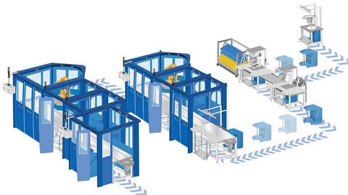
Obr.5 Ilustrovaný postup vytvárania komplexného automatizovaného montážneho systému z modulov firmy BDG http://bdg-online.de/automation/
